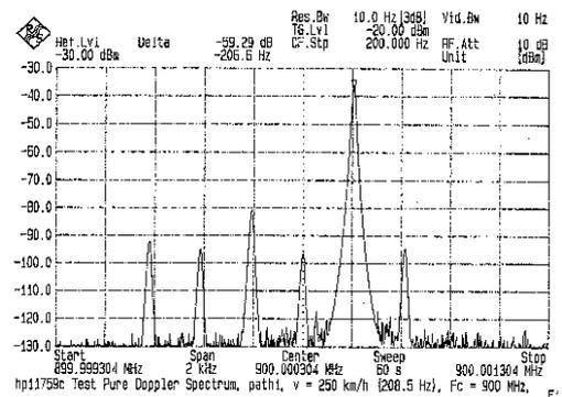
Fig.6.2 Pure Doppler shift at 250 km/h
